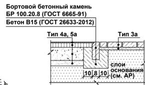
Узел сопряжения проезда из а/б с тротуаром из плитки (борт) 1:20
