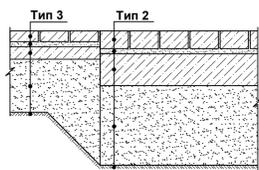
Узел сопряжения проезда из а/б с тротуаром из плитки (пониженный борт) 1:20
