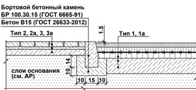
Узел сопряжения проезда из а/б с газоном (борт) 1:20
