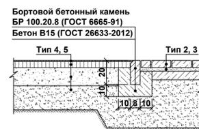
Узел сопряжения площадки с резиновым покрытием с газоном (в уровень) на эксплуатируемой кровле гаража 1:20
